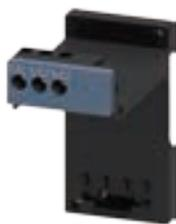
Protection contre les surcharges, les absences et déséquilibres de phases auto-alimenté • Contacts auxiliaires 1NO+1NF • Réarmement manuel ou automatique indicateur de position et fonction de test montage direct sous contacteur ou montage séparé sur rail à l'aide d'un support.
