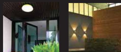
L'éclairage des porches doit permettre d'identifier l'accès du bâtiment. Il peut être réalisé par des appliques de part en d'autre de la porte d'entrée en effet **up-down** ou avec des **plafonniers** équipés d'un détecteur de présence.
