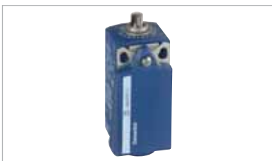
XCKP plastique Compacts, fixation par la tête 1 entrée taraudée pour presse-étoupe ISO M16 monté Encombrements du corps 31 x 30 x 65 mm IP66/IP67 selon modèle
