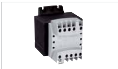
IP 2X ou xxB jusqu'à 450 VA (jusqu'à 310 VA en 12-24 V) - IK 04 Possibilité de clipsage jusqu'à 160 VA avec accessoires 0 044 16 ou 0 428 99 Transformateurs bi-tension secondaire livrés avec barrettes de couplage
