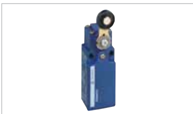
XCKN plastique Compacts, fixation par le corps Version basique pour grandes séries 10 millions de cycles de manœuvres Encombrements du corps 31 x 30 x 65 mm IP65 Pour des appareils complets avec entrée de câble Pg11, remplacer P20 par G11 (Exemple : XCK N2118P20 devient XCK N2118G11).
