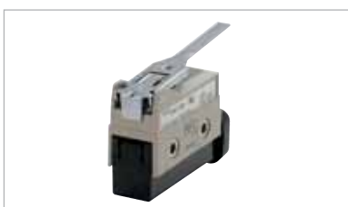
Le D4MC est très précis et a une longue durée de vie (10 000 000 d'opérations mécaniques). Il est scellé par une membrane n'utilisant pas d'adhésif ou de broche, ce qui permet de l'utiliser pour des applications nécessitant des forces mécaniques élevées et les applications nécessitant une protection contre la poussière et les gouttes- Différents modèles, plongeurs et leviers sont disponibles- IP67, UL, CSA
