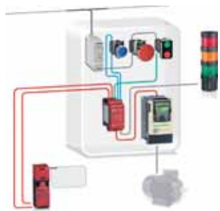
Interrupteurs magnétiques codés (Cat.4 PL e, SIL 3)
